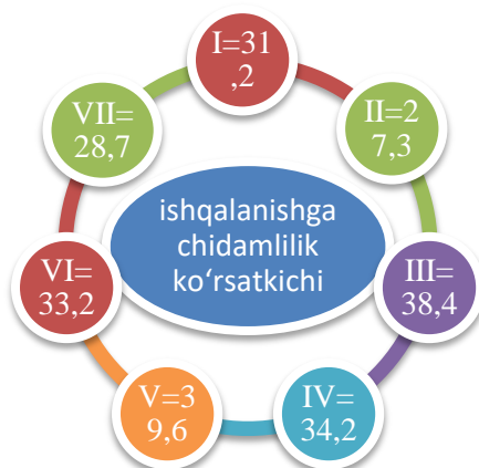
1 -rasm. ikki qatlamli trikotaj to'qimasining ishqalanishga chidamlilik ko'rsatkichi
