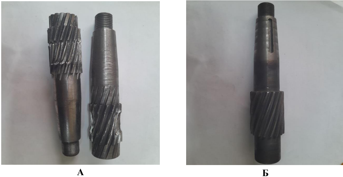
Рис.2. Вал-шестерня редуктора марки ЦУ-160. А-изношенный вал-шестерня из легированной стали ст.40X и Б-восстановленный из высоколегированной стали марки ПХ18Н9Т с термической обработкой-цементации.
