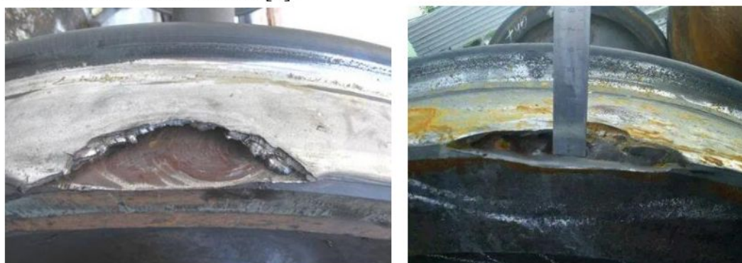
Рисунок 1 – Общие виды отколов на обода колеса длиной более 120 мм и глубиной от 10 до 25 мм.
