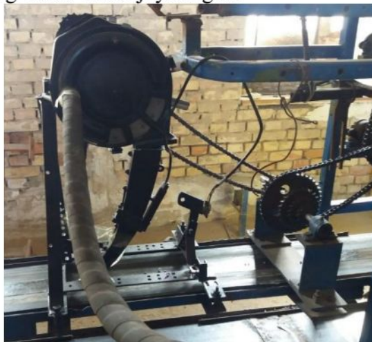
1-rasm. Case-1200 seyalkaning pnevmatik ekish apparati bilan jihozlangan laboratoriya stendining umumiy ko'rinishi
