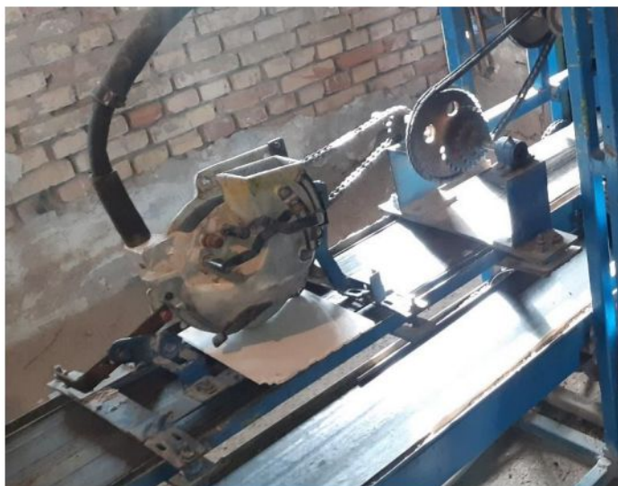
3-rasm. PS-4 seyalkaning pnevmatik ekish apparati bilan jihozlangan laboratoriya stendining umumiy ko'rinishi
