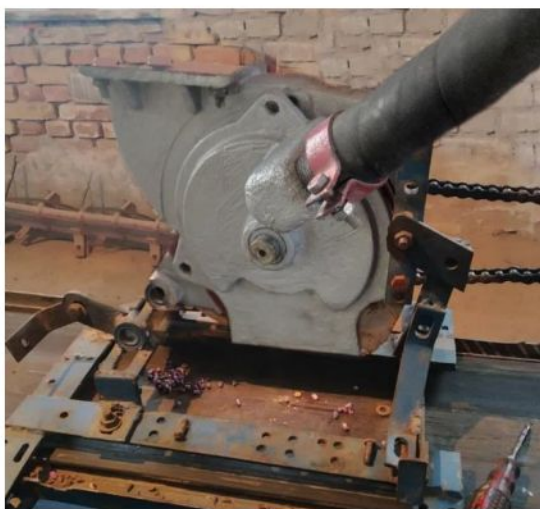
2-rasm. SMX-4-04 seyalkaning pnevmatik ekish apparati bilan jihozlangan laboratoriya stendining umumiy ko'rinishi
