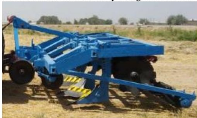
4-rasm. Takroriy ekinlar ekish uchun tuproqni ekishga tayyorlaydigan kombinatsiyalashgan agregat.
