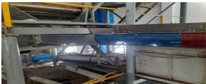
3-rasm. Presslash sexiga o‘rnatilgan yangi konstruksiyali to‘lqinsimon shakldagi vintning va yangi konstruksiyali qayishqoq elementli, to‘rli yuzaning tajriba nusxasi ko‘rinishi.
