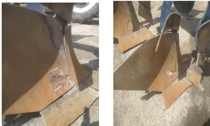
3-rasm. Texnolog plugining otvallari eyilib nosoz xolatga kelgan ko‘rinishi
